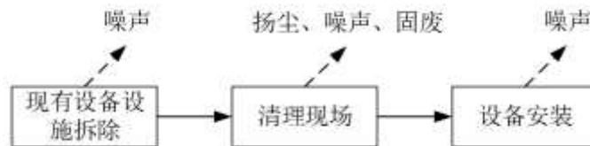
图6 施工期施工流程及产排污示意图
