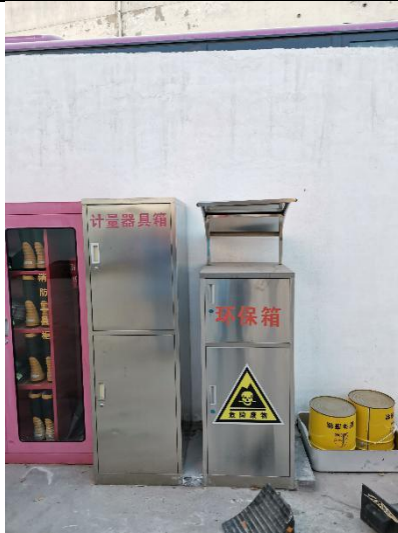
图 20 危废暂存设施
