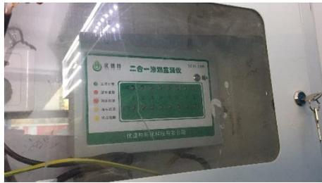
输油管线泄漏监测系统
